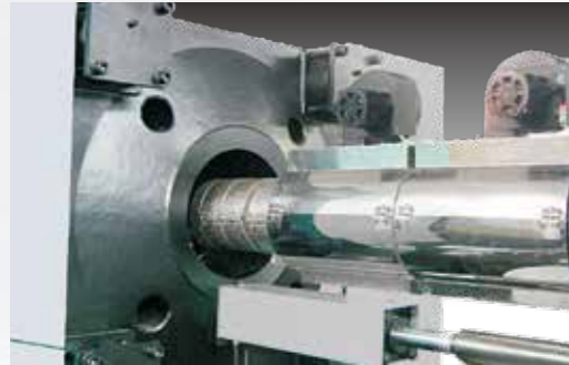
Máy ép phun chuyên dụng Ống nhựa UPVC (UPVC pipe)
