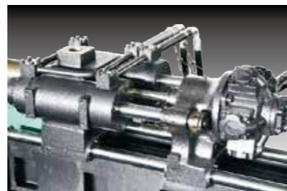
Hệ thống phun 射出システム
